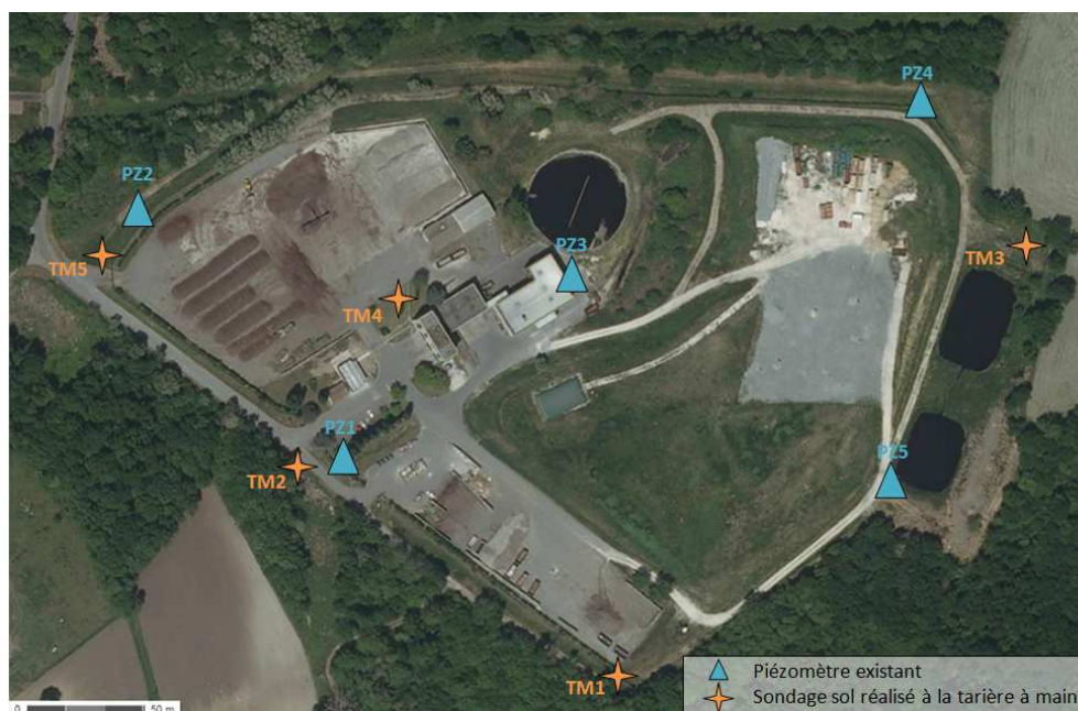
Localisation des investigations réalisées sur les sols et les eaux souterraines en juillet 2013 dans le cadre de l'élaboration du rapport de base
